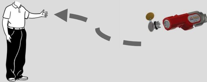
Wenn der Schlüssel in die SCP gesteckt und im Uhrzeigersinn gedreht wird, leuchtet die Signalleuchte im Inneren auf und das Tor kann geöffnet werden.
